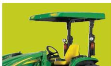
**Toit-abri :** Protégez-vous du soleil et des intempéries. Le toit-abri s'installe sur la structure de protection ROPS pour mettre le conducteur à l'abri des rigueurs de dame Nature.
