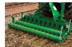
► **Service intensif** : Utilisez un pulvérisateur de service intensif et de gamme supérieure muni d'un bâti plus robuste à poutre en H pour une résistance accrue afin de travailler les sols plus denses.
