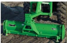
**Service moyen :** Ces lames facilitent les travaux de précision. Toutes les lames sont compatibles avec l'attelage de catégorie 1 et certaines sont compatibles avec l'attelage de catégorie 2. Les versoirs robustes ont une hauteur de 45 cm (18 po) et les bâtis sont faits de tubes d'acier ou forment un profilé en tôle pliée.
