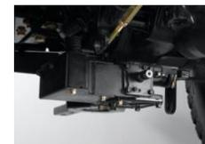
► **Répartiteur pour chargeur/tondeuse ventrale (COLIS) :** Inutile désormais de changer les tuyaux : ce colis contient un autre raccord de distributeur ventral. L'opérateur actionne tout simplement un levier et achemine le fluide hydraulique vers l'instrument qu'il veut utiliser. Vraiment pratique lorsqu'on passe de la tondeuse au chargeur.
