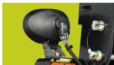
**Colis de phares avant :** Profitez d'une visibilité accrue à l'avant lorsque vous travaillez dans l'obscurité. Les deux phares se fixent aux grilles de protection situées sur la structure de protection ROPS. (Le colis de phares avant est un équipement de série sur les tracteurs à cabine.)
